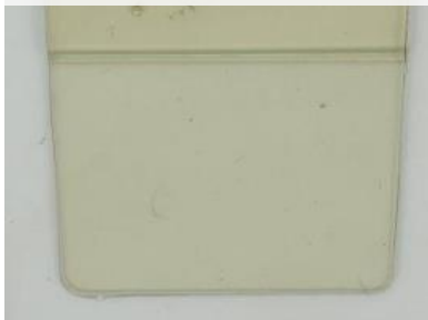
Material : PET UVA : 390B Dosage : 4,000 ppm
