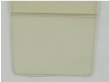
Material : PET UVA : Chiguard® GA403 Dosage : 4,000 ppm
