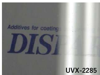
UV樹脂系コーティング材 レベリング試験
