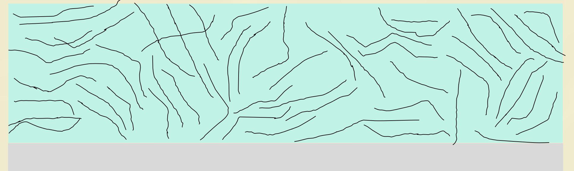
過剰分散状態 分散しすぎて導電パスが切れる
