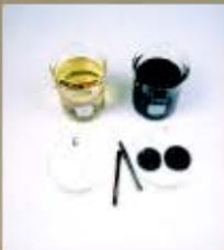
■ **シンシナティミラクロン熱安定性テスト(ASTM D 2070)**
