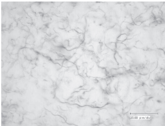
図6 RTVへTUBALL™添加した時の分散状態 (TUBALL™ 0.05% 10^6 \Omega \cdot \text{cm} )
